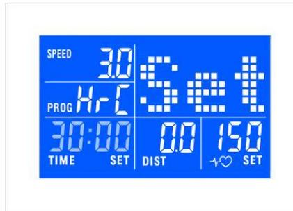
Presione START: la cinta correrá a una velocidad de 3 kph durante 2 minutos para calentar: Ajuste la elevación de manera manual.
