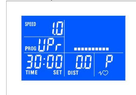
Programmare la velocità e l'elevazione per ogni segmento con  $\uparrow/\downarrow$ , e premendo ENTER.
