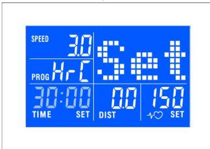
Drücken Sie auf START um mit dem Training anzufangen. Das Laufband wird 2 Minuten mit einer Geschwindigkeit von 3 km/Stunde bewegen (zum aufwärmen), die Steigung (Inklination) können Sie manuell ändern.
