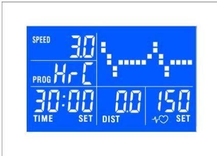
Use ↑/↓ buttons para introducir la THR (Target Heart Rate) deseada y confirme con ENTER
