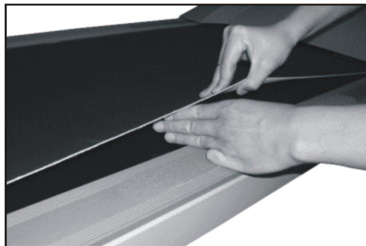
**! Importante : El aparato debe ser en un superficie plano. Si el aparato no esta estable , la cinta se ira mas hacia la parte mas inferior del aparato.**
